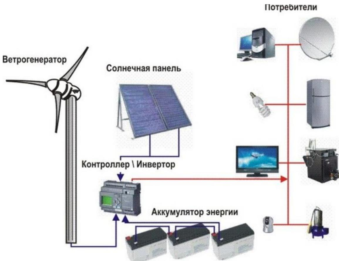
**Рисунок 3.1 – Схема комплексной системы преобразования энергий ветра и солнца в электрическую энергию.**
