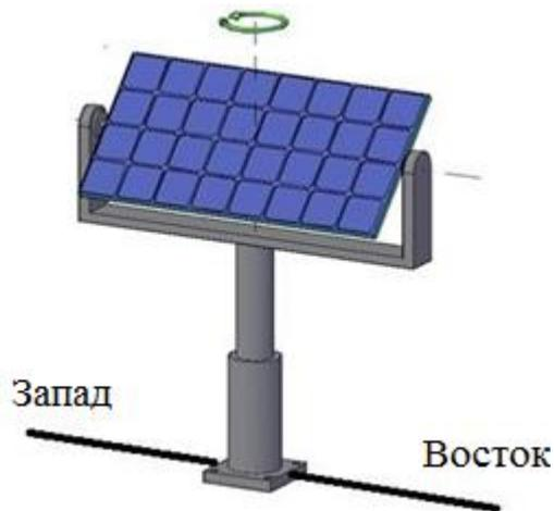
**Рисунок 2.4 – Трехмерная схема системы управления, движущейся в одном горизонтальном (азимутальном) направлении.**
